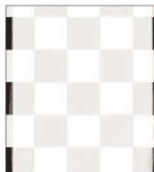
Opacidad clase 3 de pintura convencional después de una capa.
